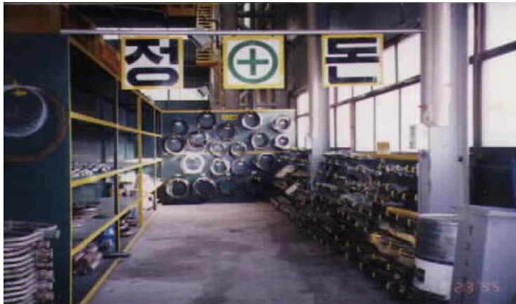
【사진 3】 잘 정돈된 보수자재정돈의 사례
