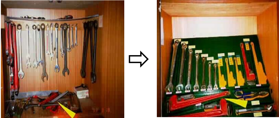
<사진 1> 공구정돈불량의 定點촬영에 의한 개선모습
